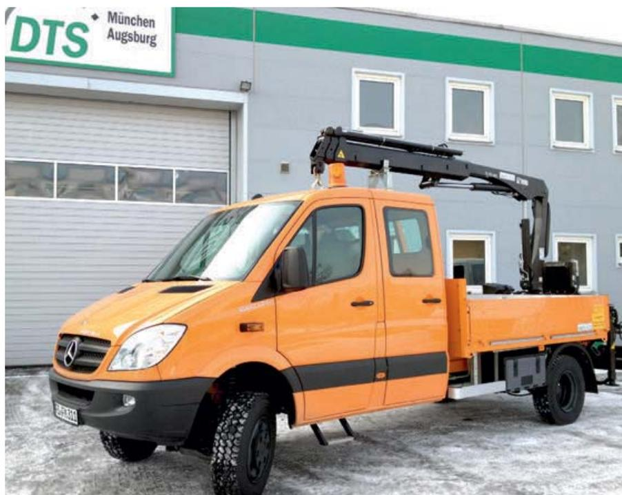
Um möglichst schnell von Einsatz zu Einsatz zu gelangen, erhielt der Allrad-Sprinter hinter der Doppelkabine zusätzlich eine Vorrichtung, auf der sich der ausgeschobene Kran ablegen lässt.
