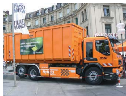
Sowohl der Diesel getriebene Volvo FM (links) als auch der baugleiche Volvo FE Hybrid sind mit dem gleichen Hiab Multilift-Abrollkipper des Typs XR18S59 versehen. Der Test kann beginnen.
