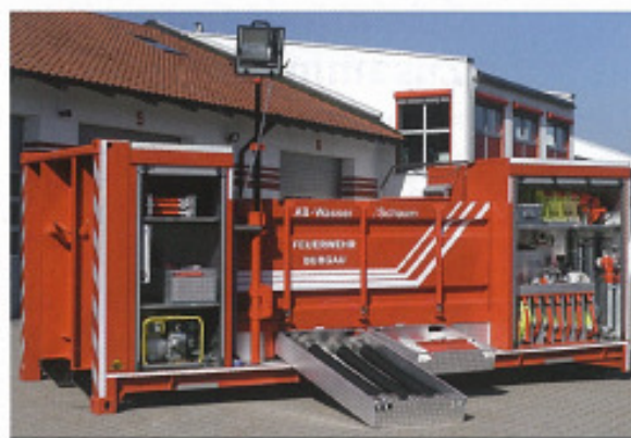
AB-Wasser/Schaum: Blick auf die Beladung der Geräteräume G1 und G3. Unter dem Löschwasserbehälter sind die Saugschläuche sowie die Schlauchbrücken gelagert.
