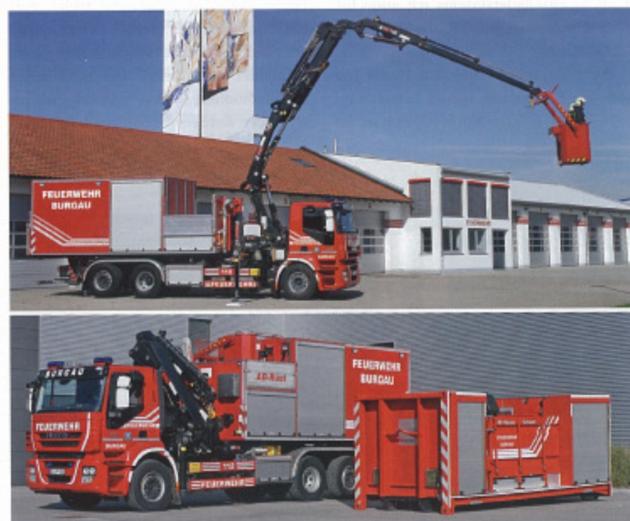
oben: An die Kraneinrichtung des Wechselladerfahrzeugs kann ein Korb montiert werden. unten: Das Wechselladerfahrzeug der FF Burgau mit AB-Rüst und AB-Wasser/Schaum
