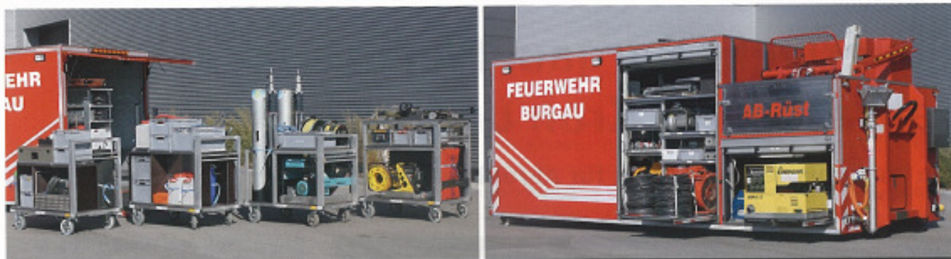
links: Im heckseitigen Geräteraum des AB-Rüst sind vier Rollcontainer gelagert. rechts: Die feuerwehrtechnische Beladung der Geräteräume G2 und G4
