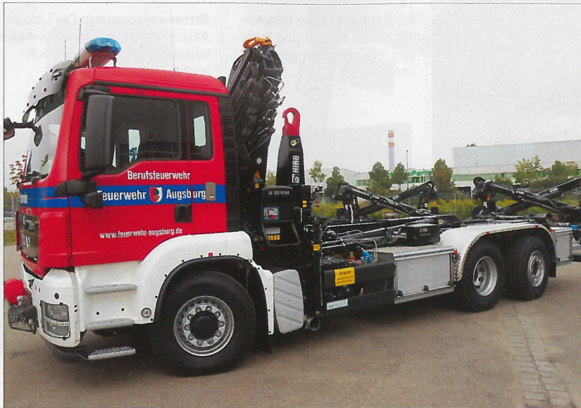
Aufbau: Der Ladekran ist zwischen Lift und Fahrerhaus des MAN platziert.
